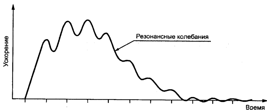
Рисунок 4 — Отклик акселерометра на удар
